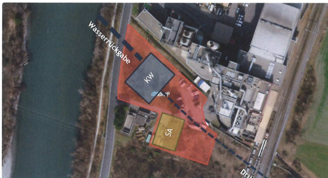
Abbildung 2: Schematische Darstellung der wichtigsten Kraftwerksanlagen (KW: Kraftwerkszentrale, SA: Schaltanlage). Die tatsächlichen Anordnungen und Ausmasse werden im Rahmen des Bauprojekts bestimmt. Für das ARA-Pumpwerk verbleibt genügend Platz.
